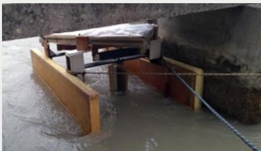
Test du démonstrateur hydrolien VH quatorzevingtreize en site réel dans un canal à Cheval-Blanc (Vaucluse)
